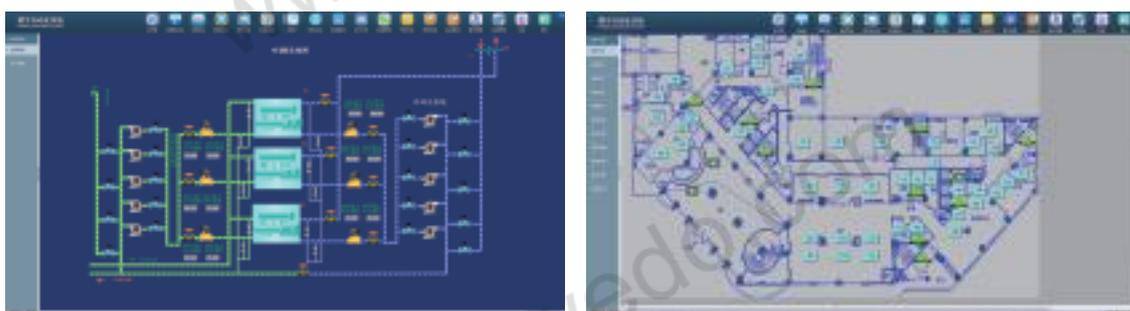
对空调冻却水进出温度、回水温度、环境温度、热泵机组运行状况等进行实时监测分析，为管理人员提供数据依据。
